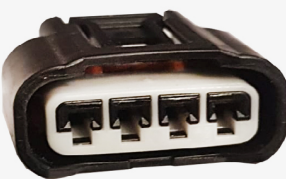
FIV-675 Conector Bobina de ignicion Toyota corolla
