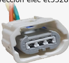
FIV-756-1 Ficha 3 vías lampara y Inyeccion electronica tc1800 et5527
