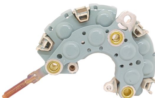
FA-N-1525 Placa Nippondenso 021580-4990 Toyota, Acura, Isuzu, Suzuki CON DIODO AUXILIAR
